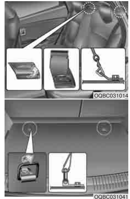
Крепление детского кресла с помощью системы привязных креплений “Tether Anchor” (при наличии)
